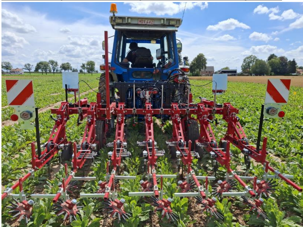
Figuur 15. Stekete camera-gestuurde schoffel met kantmessen en vingerwieders.
